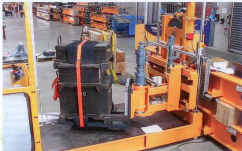
In ausführlichen Belastungstests wurde die neue Lösung im Werk Bischweier auf ihre Dauerfestigkeit erprobt
