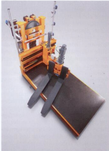
Nachher: Da die neue Schwenkschubgabel einen ausreichenden Fahrweg hat, kann auf die Zusatzbewegung des Pantografen verzichtet werden. Seitenschub und Drehbewegung laufen synchron ab
