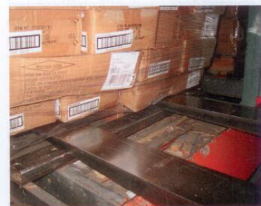
Lastaufnahme auf der Schrägrollbahn in zwei Schritten: Nach dem Absetzen auf dem Querprofil steht die Palette waagrecht, und die Gabel kann ganz eintauchen
