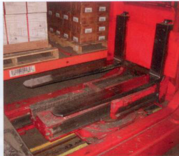
Vorher: Die Schwenkschubgabel am alten RBG war zusätzlich mit einem Scherenhub (Pantograf) ausgestattet. Die Gabel saß hierzu auf einem eigenen Schlitten (kurze Wangen) – nur so konnte die erforderliche Ausfahrtiefe bei gegebener Gassenbreite erzielt werden
