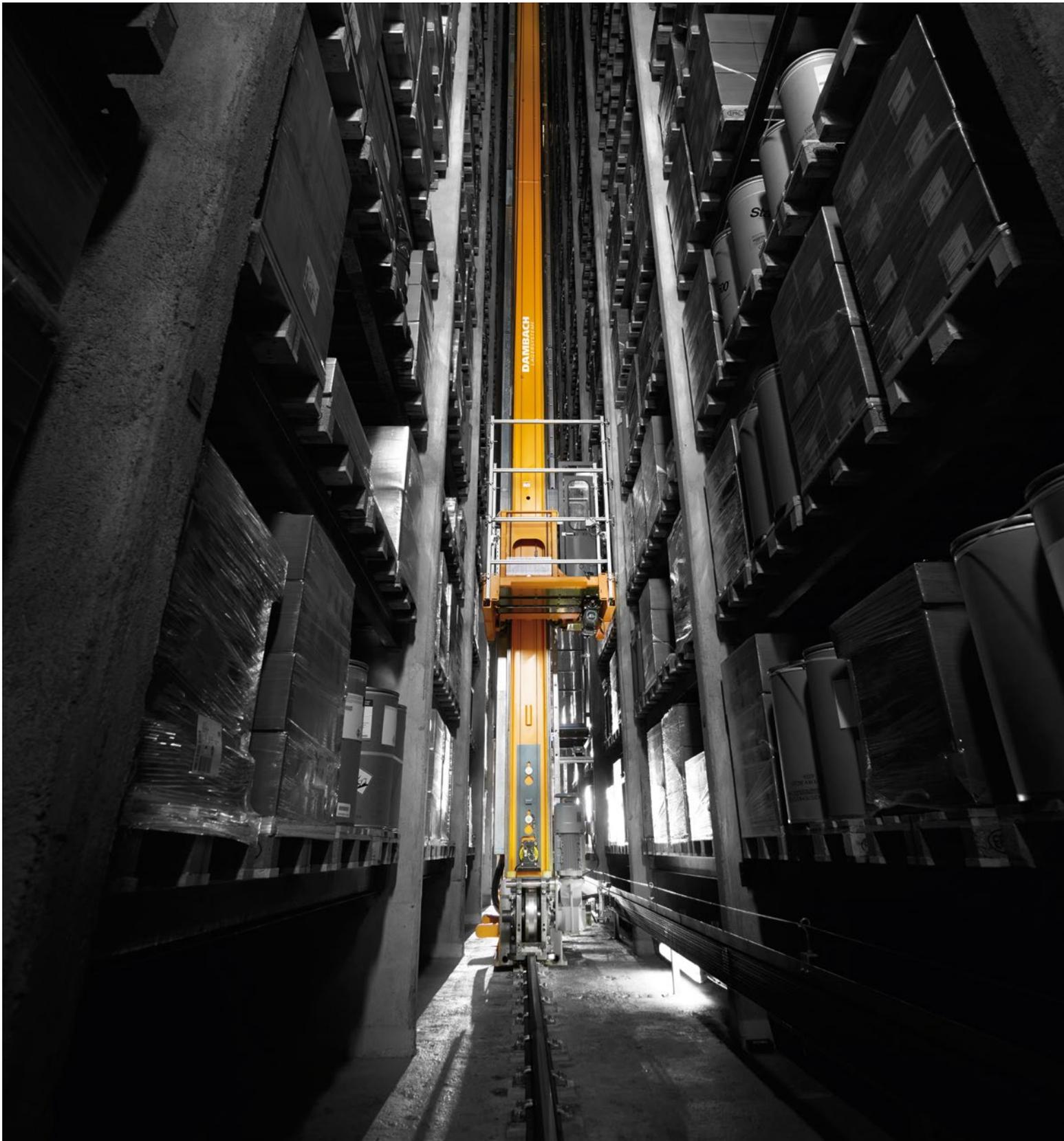
Die beim Bremsen und Senken wiedergewonnene Energie wird in Power Caps gespeichert. Eine NetZRückspeisung entfällt. Die Bereitstellung dieser Energie erfolgt direkt und effizient. Der Wirkungsgrad wird verbessert.
